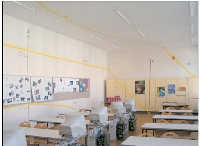
liegt. Am 21. März und am 23. September ist der Kegel zu einer Ebene entartet (Öffnungswinkel:  $180^\circ$ ). Die Sonnenbahnen sind Geraden an der Südwand, die sich in Geraden an der Ost- und Westwand fortsetzen. Am 21. Juni liegt die Sonnenbahn auf einem nach Norden geöffneten Hyperbelast an der Decke, der sich in nach oben geöffneten Hyperbelasten an der Ost- und Westwand und schließlich auf nach oben geöffneten Hyperbelasten an der Nordwand fortsetzt.
